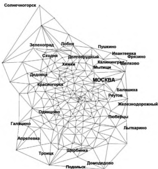
Схема спутниковых измерений при реконструкции Московской городской геодезической сети [52]
