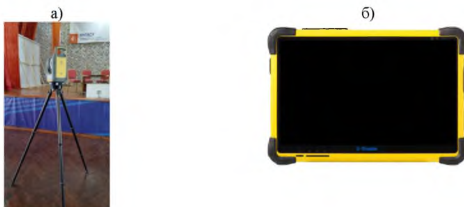
Рис. 1. а) Лазерный сканер Trimble-X7 б) планшетный контроллер Trimble-T10
