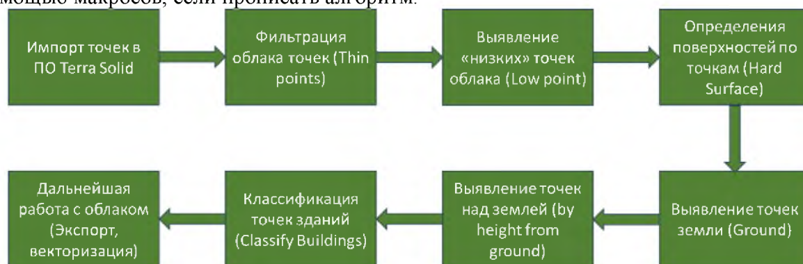
Рис. 1. Схема фильтрации и классификации облака ТЛО
