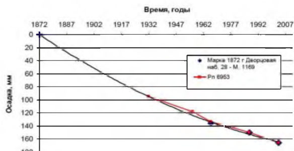
Рис. 31. Осадки здания дома № 28 на Дворцовой набережной и репера № 6953, расположенного вблизи марки Савицкого № 1169 [5]
