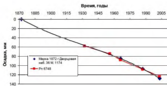
Рис. 32. Осадки здания Государственного Эрмитажа (д. № 36 на Дворцовой набережной) и репера № 6748, расположенного вблизи марки Савицкого № 1169 [5]
