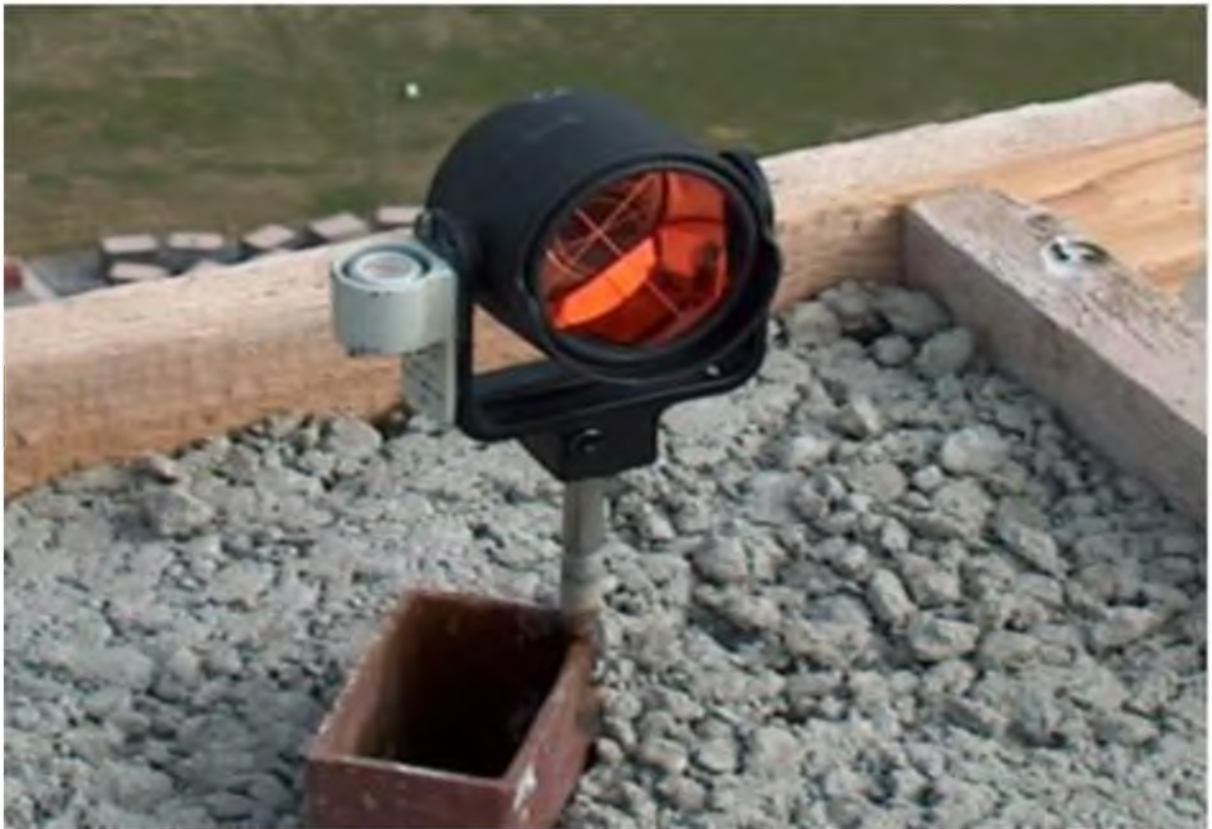
Рис. 4. Вид центров геодезических опорных сетей (возможные варианты)
