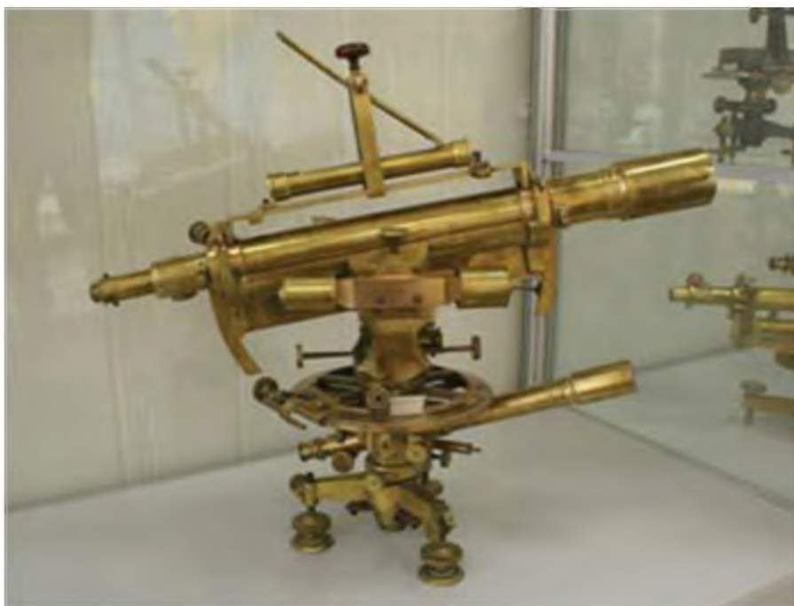
Рис. 1. Нивелир-теодолит конструкции Э. И. Форша, названный по имени изготовителя пулковского механика Г. К. Брауэра «Нивелир-теодолит Брауэра»
