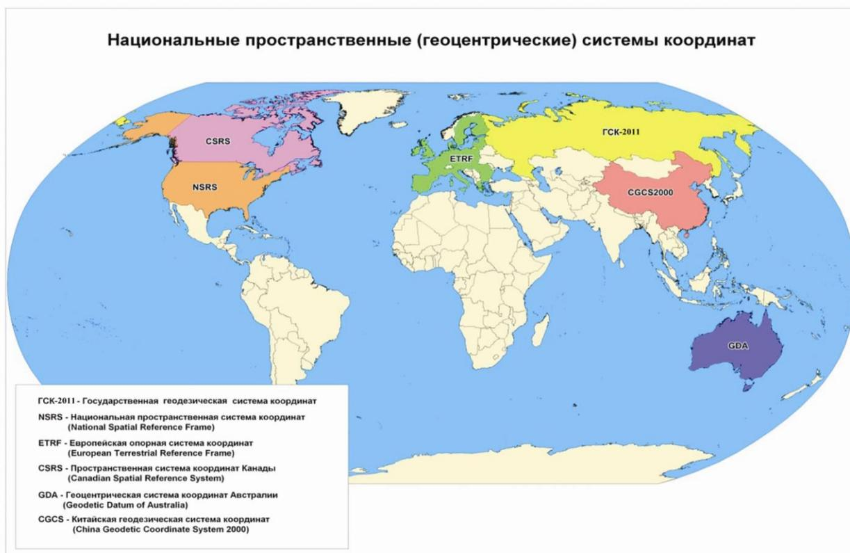
Рис. 4. Национальные геодезические системы координат [1, 2, 9, 10].
