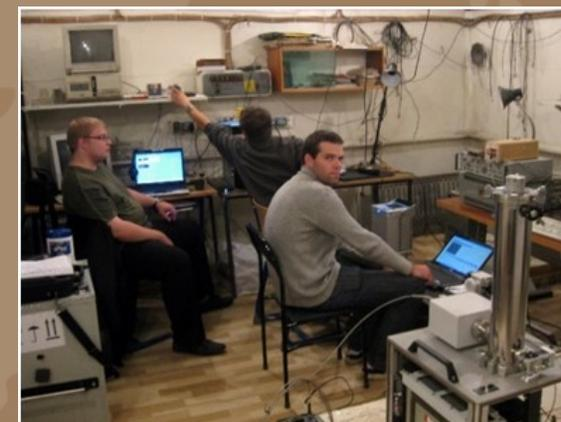
Абсолютные измерения силы тяжести баллистическим полевым лазерным гравиметром. За прибором сотрудники Геодезического отдела ЦНИИГАиК Р.А. Сермягин, А.В. Басманов
