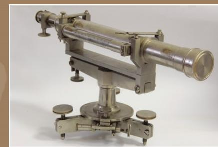
Триангуляционный теодолит ТТ 2/6, астрономический универсал АУ 2/10, прецизионный нивелир, изготовленные в начале 1930-х гг. на заводе «Аэрогеоприбор» по техническому заданию, разработанному под руководством Ф.Н. Красовского
