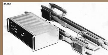
Топографический гидролокатор бокового обзора ТГБО
