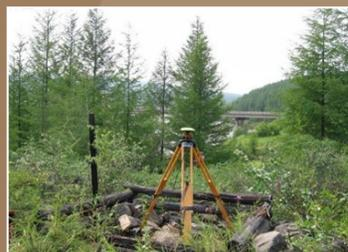
Спутниковые измерения на пункте ГВО
